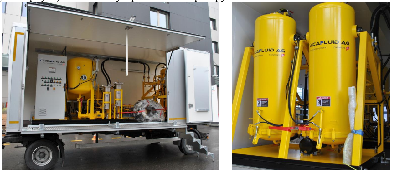
Фото 5.17. Двох-стадійна регенераційна установка Micafluide®
