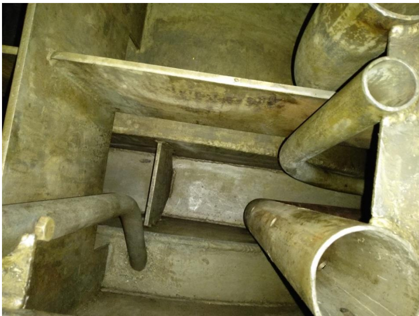
Фото 5.24. Картер опори №2 (підшипники № 2, № 3) після гідродинамічного очищення
