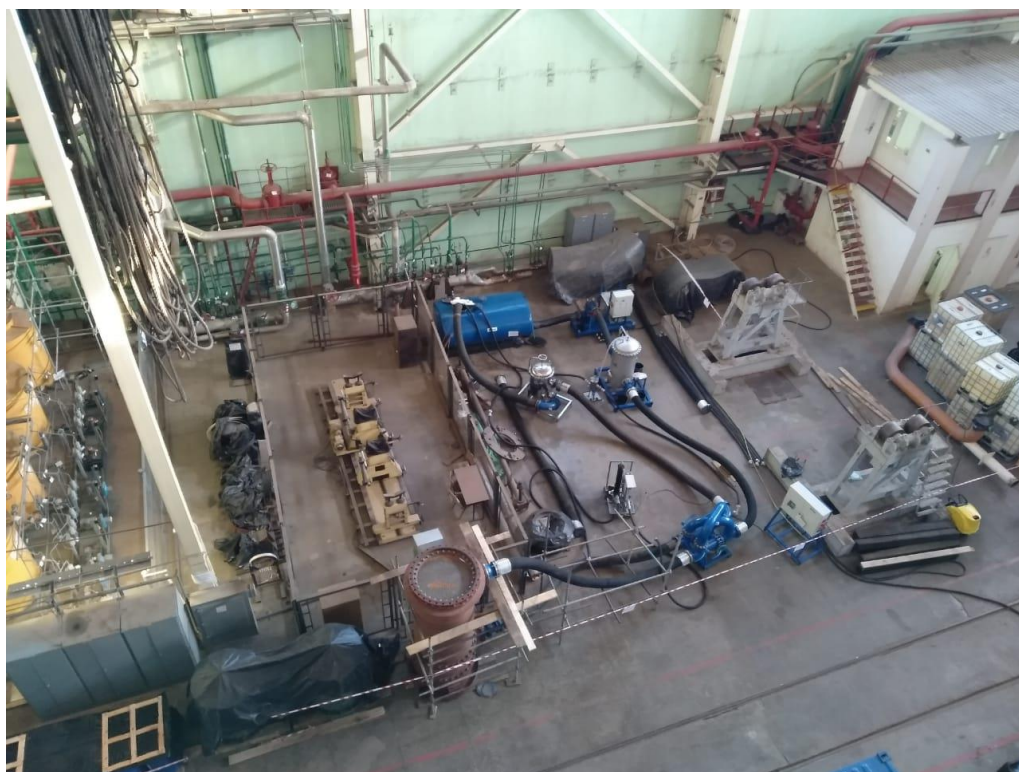
Фото 5.20. Загальний вигляд схеми промивання охолоджувача оливи М-540.
