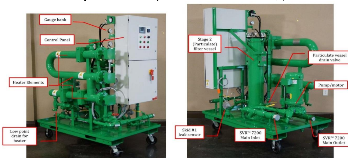
Фото 5.5. Установка SVR 7200 (Stage 2: насос, підігрівач, фільтр механічної фільтрації).
